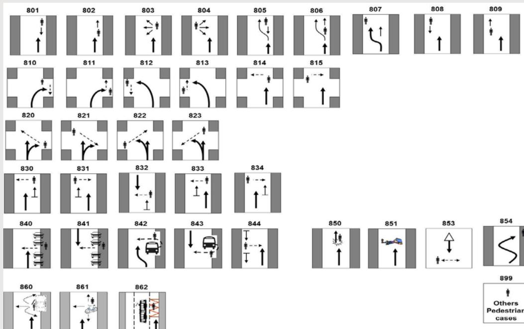
**810** : Piéton en intersection ; véhicule en tourne à droite avec piéton traversant sur axe perpendiculaire de la gauche vers la droite
